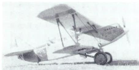
**ARMAMENTO.** - Los NATCHAS R Z, estaban armados de 1 ametralladora PV-1 fija, tirando a través de la hélice y de 1 SHKAS 7,62 m/m., 800 disparos, móvil, en la cabina del ametrallador. Podía cargar 8 bombas de 50 kg., ó 4 de 100 kg., ó 2 de 250 kg., suspendidas en el plano inferior, o el equivalente en bombas de 25 kg.
