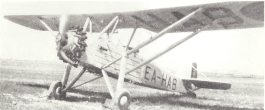
Hispano E-30, con la torreta-soporte de ametralladora en la cabina trasera del observador.
