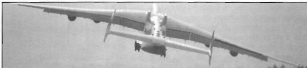
En ésta inusual vista del gigante ruso despegando, se aprecia la enorme cola bideriva que facilita las cargas en el dorso del fuselaje. Fuente: Aerospace Publishing Limited, 1997
